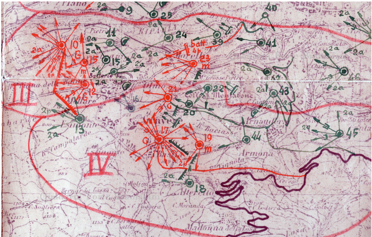
Pianta di progetto della 3 linea della sistemazione difensiva a Gravera con l'ubicazione delle opere di difesa, in rosso quelle in corso di costruzione, in verde quelle in progetto. Gli ovuli rossi si riferiscono ai diversi appalti di lavoro in corso. AUSSME, Studi particolari , rep. L3, r. 28.
