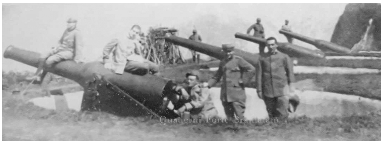
Pezzi da 149 G (ex 15 GRC Ret.) suo affusto con sottoaffusto modificato a perno centrale
