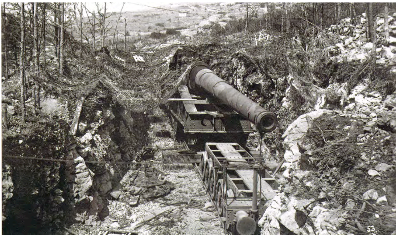
Pezzo d'artiglieria ferroviaria da 340 mm modello 1893 su affusto a scorrimento Schneider n° P3059 "La Fanchette III" visto da sinistra
