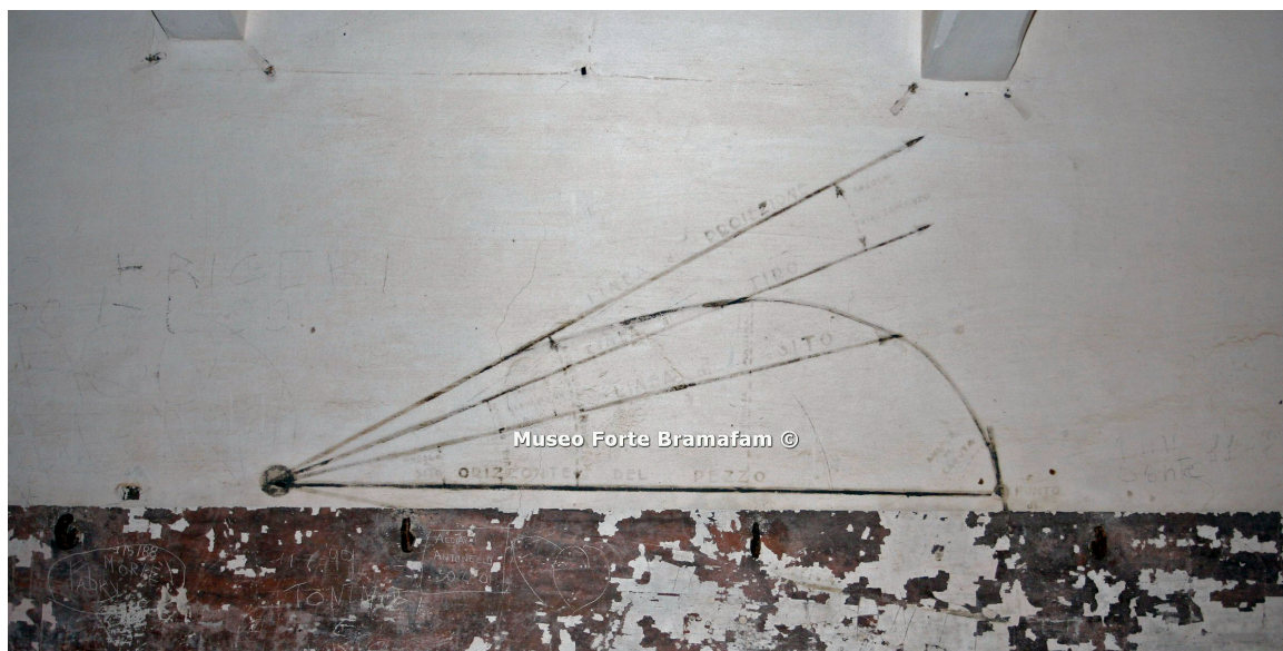
Su una parete della Caserma Comando ormai evanescente una tavola con le indicazioni di elevazione dei pezzi; partendo dall'alto: linea di proiezione, linea di .... di tiro, linea di ..... sito, orizzonte del pezzo
