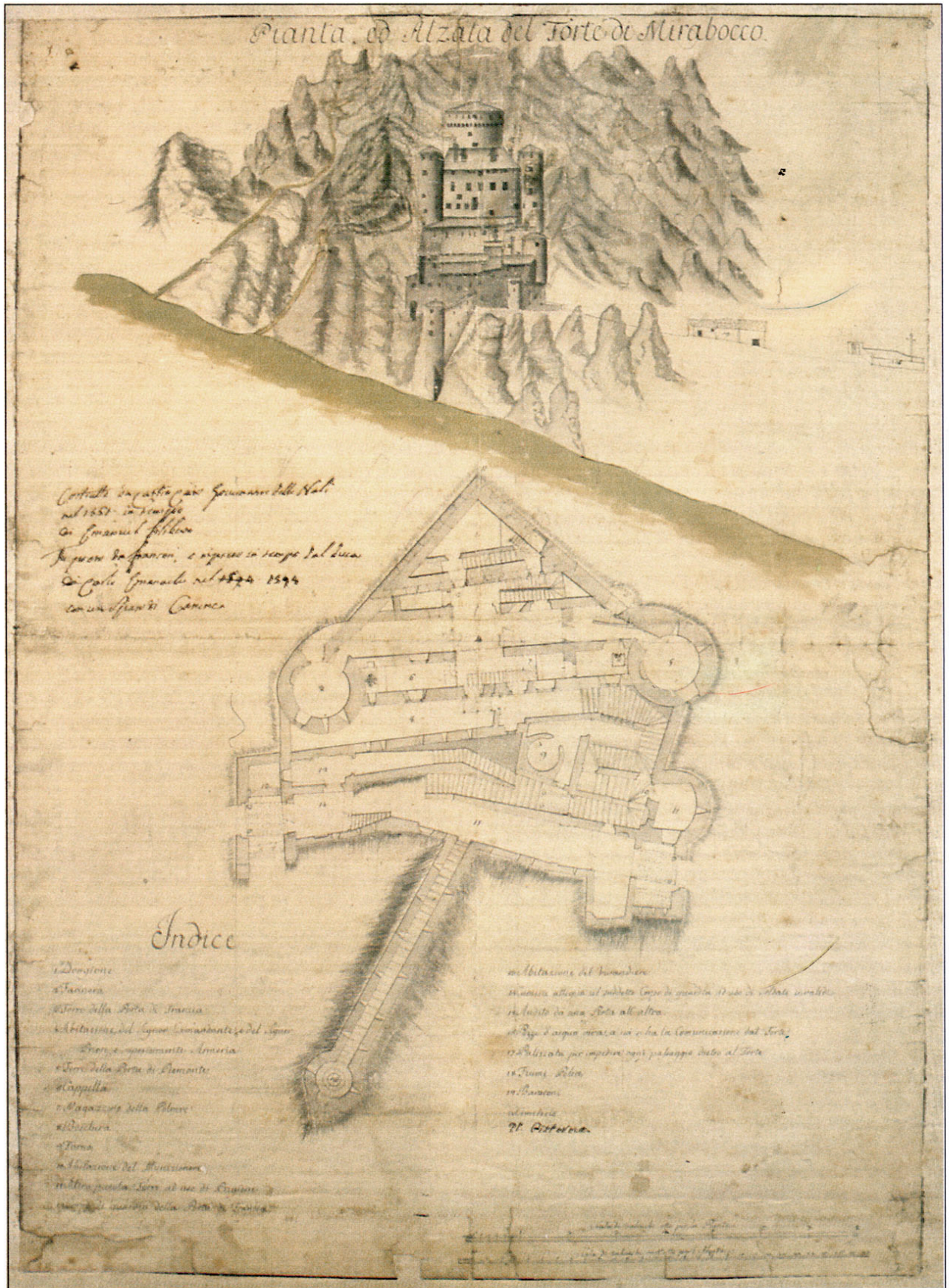
Disegno riguardante il Mirabocco riportato dal Pons. Il forte compare nella sua struttura definitiva, compresi i due ponti levatoi non presenti negli altri disegni. Nella scritta in alto a sinistra, aggiunta successivamente, leggesi: "Costruito da Castro Caio Governatore delle Vali / nel 1561 in tempo / di Emanuel Filiberto / Fu preso da francesi, e ripreso in tempo dal Duca / di Carlo Emanuele nel 1594 / con uno Sparo di Canone".
